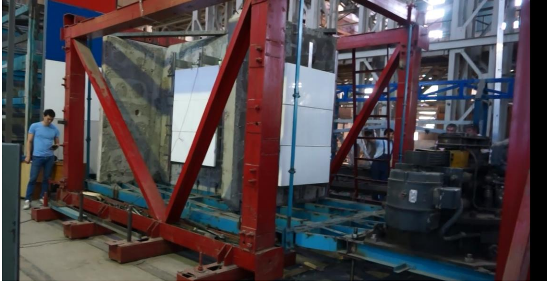
Рис. 4.3 Общий вид экспериментального стенда после установки на виброплатформу.
