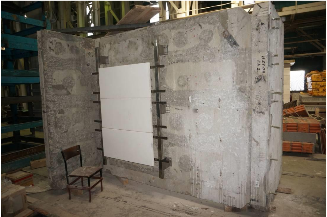
Рис. 4.2 Общий вид экспериментального стенда в момент крепления облицовочных плит.
