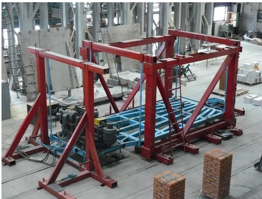
Рис. 1.2 Общий вид виброплатформы маятникового типа.
