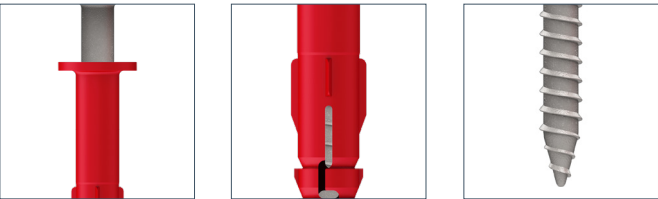
Бортик дюбеля предотвращает возникновение контактной коррозии
