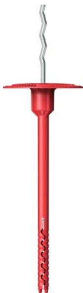
Предназначена для установки в основные типы строительных оснований в многослойной кладке. Служит для соединения основания со штучной облицовочной и фиксации теплоизоляции с формированием воздушного зазора.
