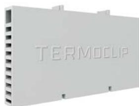
Предназначена для установки в вертикальные кладочные швы. Обеспечивают вентиляцию и вывод конденсирующейся влаги из воздушного зазора между облицовочной и несущей конструкциями.
