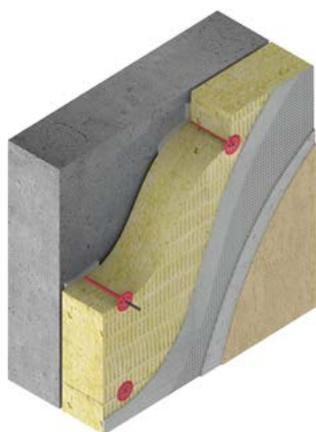
Предназначен для крепления теплоизоляционных плит к несущему основанию в фасадных системах наружного утепления, как с тонким штукатурным слоем (СФТК), так и с воздушным зазором (НФС).
