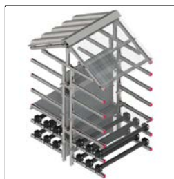
Крепление кабеля на эстакадах.
