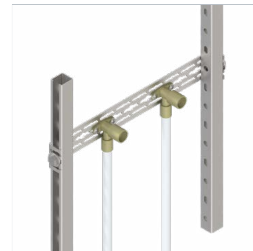
Крепление водорозеток к элементам несущего каркаса
