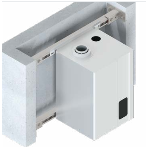
Крепление котла отопления в распор к несущему основанию
