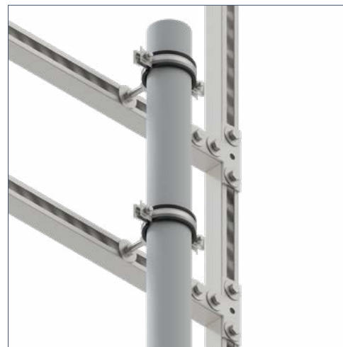
Крепление вертикального участка трубы к фальшштене
