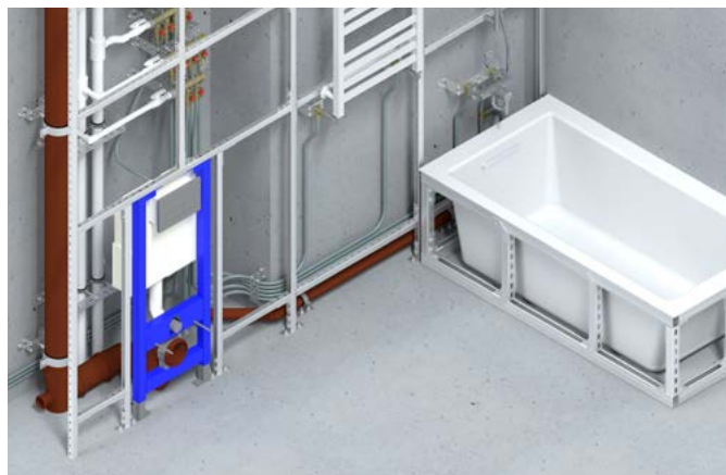
8. Крепление сантехнического оборудования и фальш-стен
