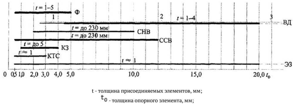
Ф - фальцовка; ВД - дюбель высокопрочный (1, 2 и 3 - "легкий", обыкновенного качества и высшего качества соответственно); СНВ - самонарезающий винт; СНВ - самонарезающий винт; КЗ - комбинированная заклепка; КТС - контактная точечная сварка; ЭЗ - электрозаклепки
